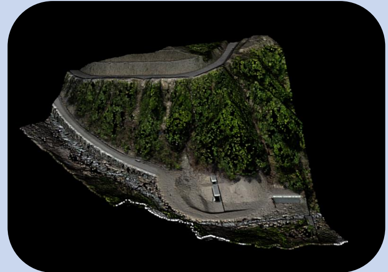
UAVレーザー測量による点群
