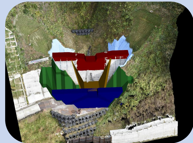
堰堤+側壁+副堰堤掘削計画
